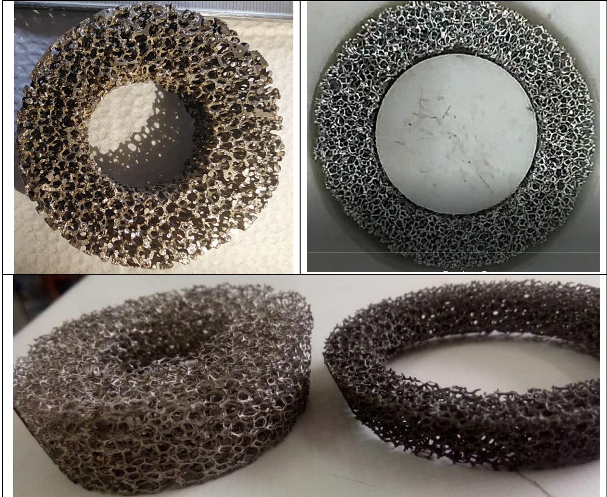
شکل ۹: تنوع سایلنسرهای شیر گاز محوری انتقال گاز تولیدی شرکت نوین رهیافت.
