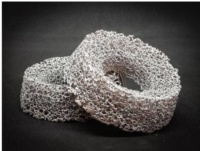
شکل ۱: نمونه فوم سلول باز تولیدی از جنس نیکل برای استفاده به عنوان ساینسر در ولو اکسیال گاز.
